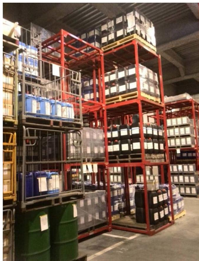
面積の狭い倉庫で、高さを生かして4段積みにて化学品を保管。
